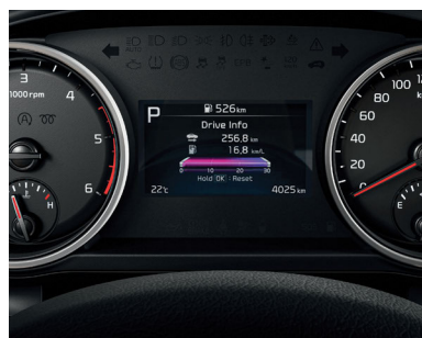
4,2-дюймовый TFT ЖК-дисплей приборной панели
