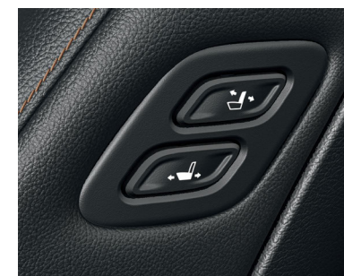
Управление креслом пассажира для облегчения посадки и выхода
